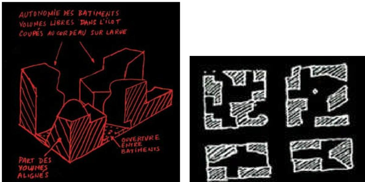
Figure 6 : Schémas expliquant l'implantation des bâtiments au sein de l'îlot ouvert (source : site web de l'atelier Christian de Portzamparc : [www.chdeportzamparc.com](http://www.chdeportzamparc.com))
