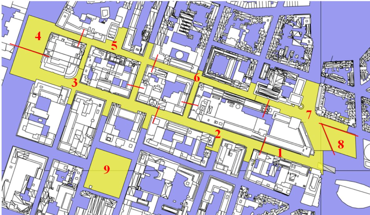
**Figure 15 : Surfaces de contrôle considérées dans l'analyse de l'impact du projet sur l'éclairage à l'échelle restreinte de son périmètre étendu à deux espaces publics limitrophes**
